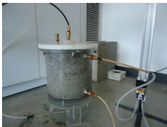
Figure 3-4 : Essai de perméabilité dans le perméamètre pour les stériles
