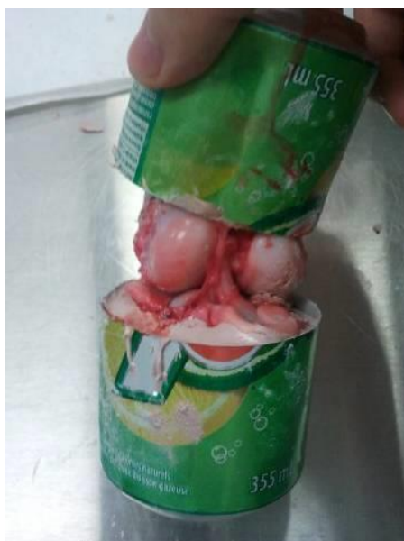
Figure 8-4, échantillon de type os-ligament-os cimenté dans un moule en canette d'aluminium.
