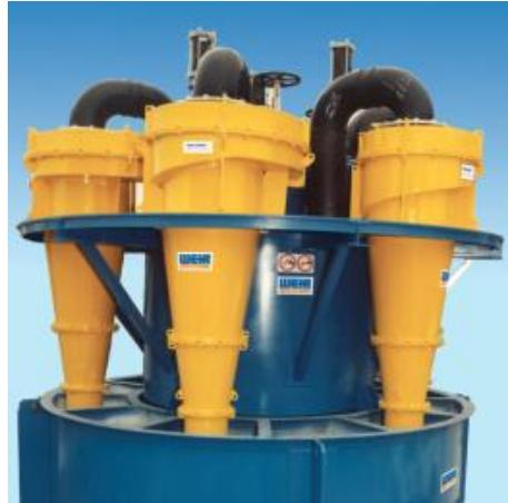
Figure 2.3 : Appareils hydrocyclones (d'après Belem 2013).
