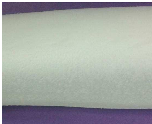
Figure 3-19: Aspect de la mousse obtenue avec une filière de type 'pancake'.
