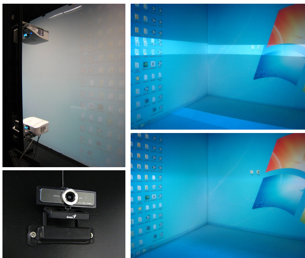
Figure 3.2 Deux projecteurs par écran (en haut à gauche). Caméra utilisée par AnyBlend (en bas à gauche) pour réaliser la fusion des images (à droite).
