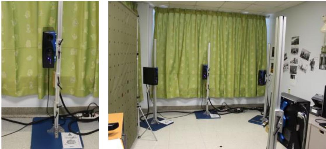
Figure 3-33 : Le système Inspect : Une caméra Inspeck (gauche), un ensemble de quatre caméra Inspeck (droite) : une de face, deux à 30° de chaque côté et une à l'arrière du sujet.
