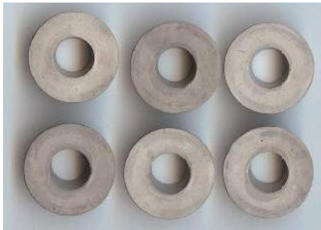
Figure 6.1 : Photos d'une vue de dessous des pièces d'inconel 625 frittées.
