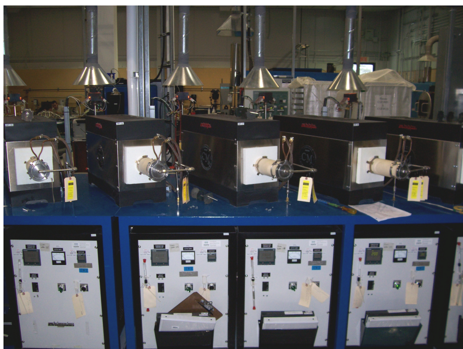
Figure 4.9 : Photo des fours tubulaires de frittage.
