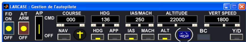
Figure 5.1 Panneau du pilote automatique
