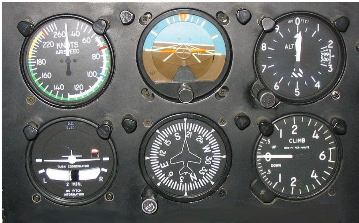
Figure 1.1 Les six instruments de vol de base. En commençant en haut à gauche : l'indicateur de vitesse, l'horizon artificiel, l'indicateur d'altitude, l'indicateur de virage, de cap, et l'indicateur de vitesse de montée (variomètre). Les quatre principaux instruments de vol (indicateur de vitesse, d'altitude, horizon artificiel et cap) ont une disposition en forme de T pour faciliter le parcours visuel dans la boucle de contrôle. Image libre de droit.
