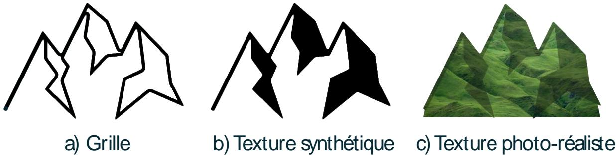
Figure 2.2 Trois représentations de terrain pour un écran SVS respectant les trois exigences de manipulation de l'encombrement.
