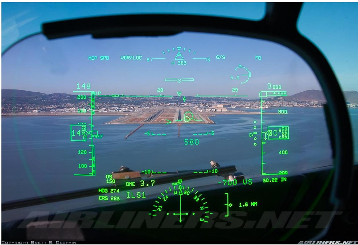
Figure 4.1 Écran HUD du Boeing 737-832 en approche à l'aéroport de San Francisco. Photo de Brett B. Despain, utilisée avec la permission de l'auteur (Despain, 2008).
