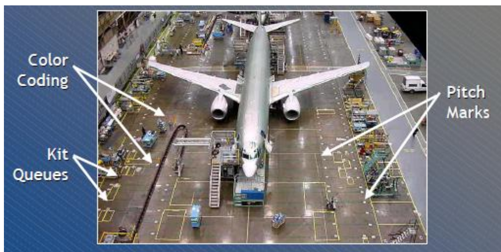
Figure 1.10 : Exemple de gestion visuelle d'une chaîne d'assemblage de Boeing (Becker, 2003).
