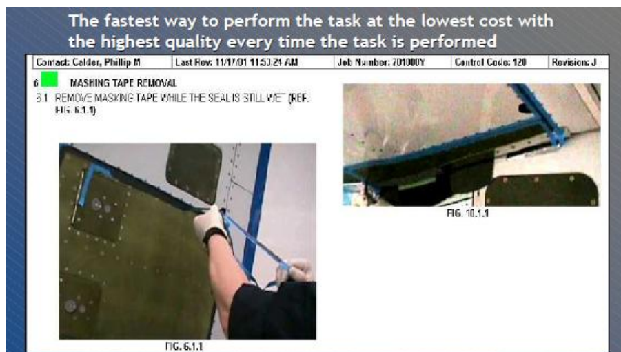
Figure 1.7 : Exemple d'instruction de travail standard dans une chaîne d'assemblage de Boeing (Becker, 2003)
