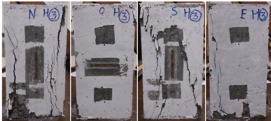
**Figure 5.12 – Rupture fragile proche du fendage. Vues de CARH\_A150\_L300-3**
