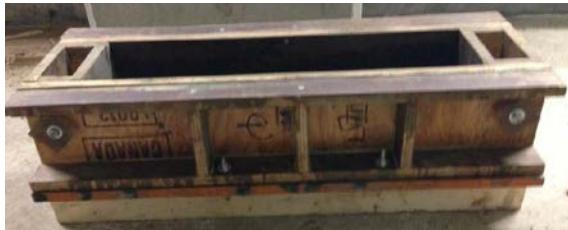
**Figure 5.2 - Photos des coffrages pour les spécimens de sections carrées coulée horizontalement**
