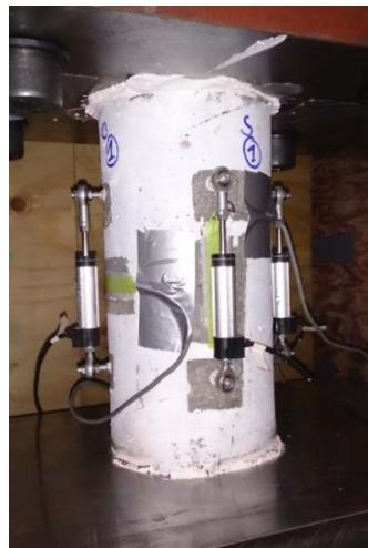
**Figure 5.4 - Photo du montage d'un spécimen cylindrique de 150 mm de diamètre et de rapport d'élancement 2 sur la presse Instron**
