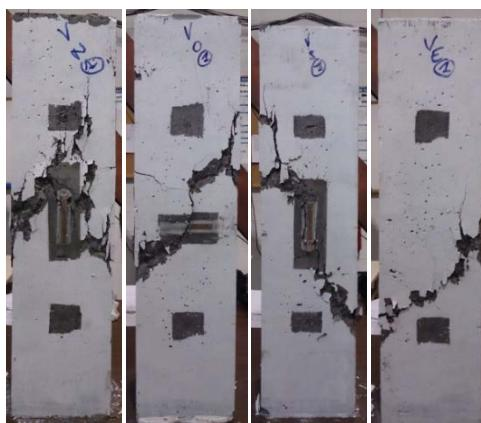
**Figure 5.14 - Rupture pseudo-fragile avec une seule macrofissure. Vues de CARV\_A150\_L600-1**
