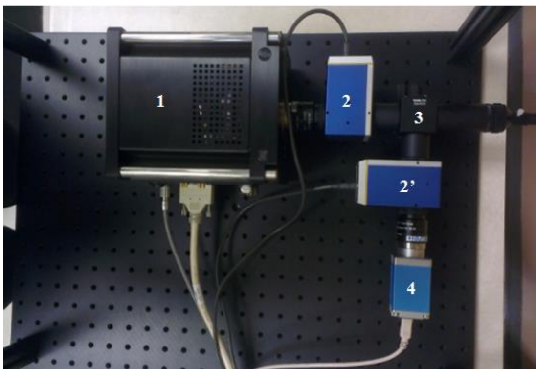
Figure 4-4: 1) Caméra EMCCD hNü de Nüvü Camēras; (2 et 2') Filtres accordables de type à cristaux liquide dans le NIR et visible. Le filtre en (2') peut être enlevé, dépendant de l'utilisation du système. (3) C'est ici qu'on installe le séparateur de faisceau 0,1/0,9 ou NIR/VIS, dépendant de l'utilisation du système (4) Caméra CCD Pixelfly.USB de PCO.
