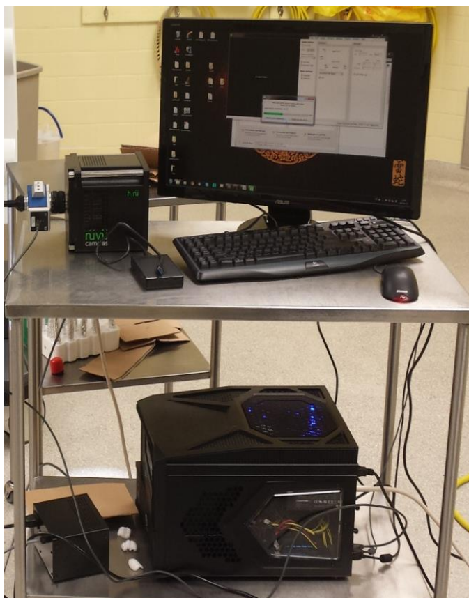
Figure 2-13: Système ultrasensible en champ large en salle d'opération sur un charriot chirurgical.
