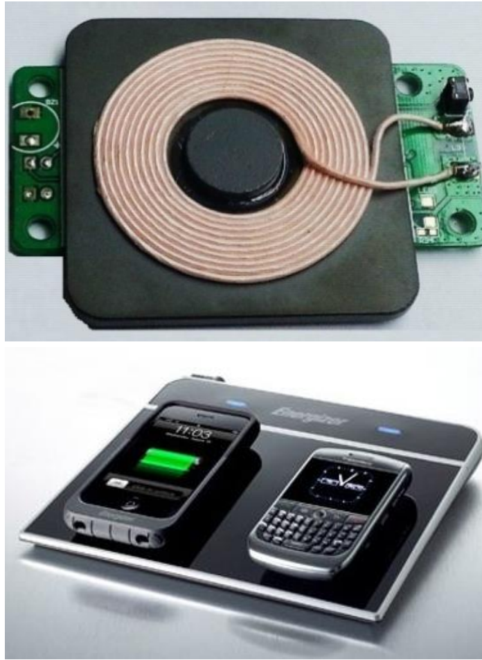
Figure 1.3 Transfert de puissance sans fil par le couplage non-r ésonant [8]
