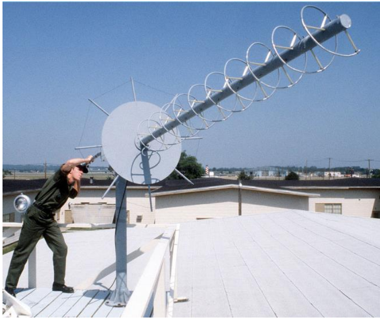
Figure 1.1 Transfert de puissance sans fil par une antenne à grande directivité [8]
