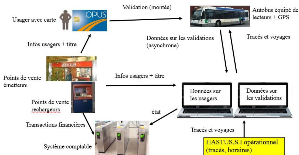
Figure 1-1 Diagramme fonctionnel du paiement par cartes à puce (Inspirée de TRÉPANIÉ, 2004)
