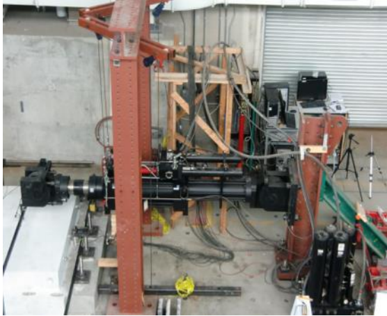
a) Portique, poulies et câbles
