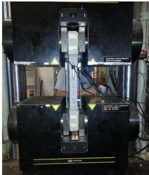
Figure 4-31: Conditions frontières lors d'un essai de traction directe sur os
