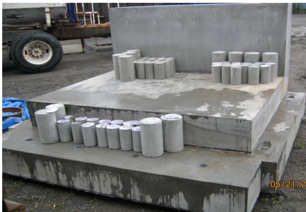
Figure 4-13: Dalle, trottoir et parapet en BHP avec cylindres de caractérisation
