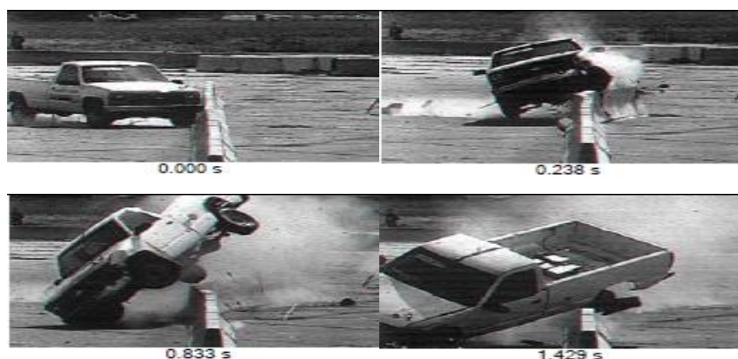
Figure 2-7: Interaction véhicule-structure non souhaitée (Albin et al.)
