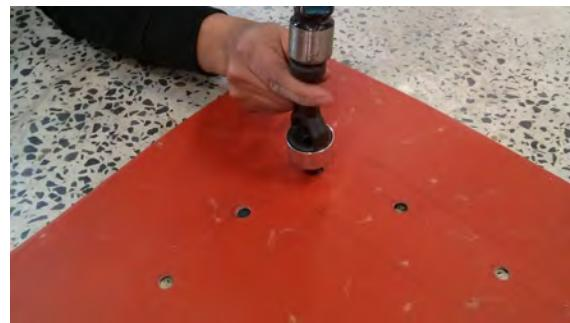
(a) Perçage des trous de passage des vis
