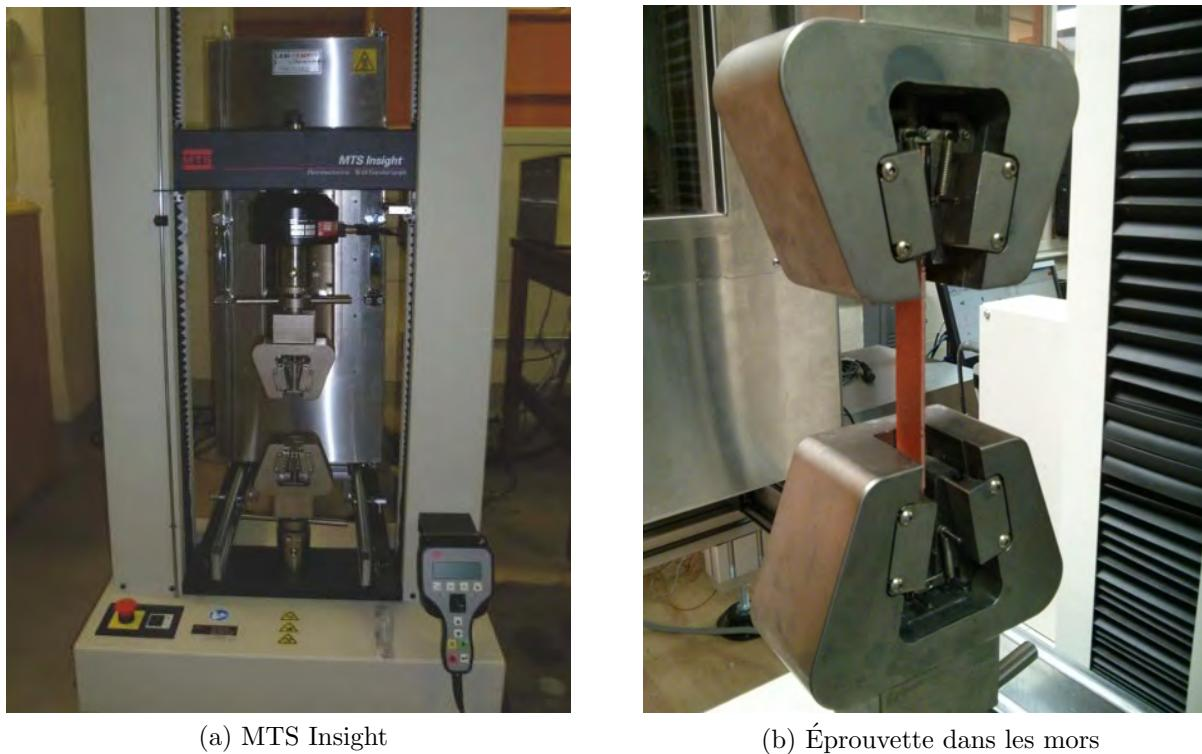
Figure 5.9 Matériel utilisé pour les essais de traction – (a) MTS Insight – (b) Éprouvette dans les mors
