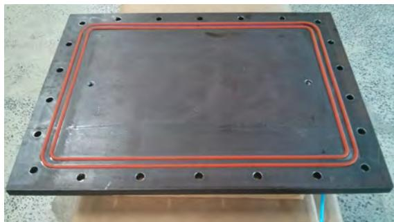
(b) Joints d'étanchéité sur le plateau
