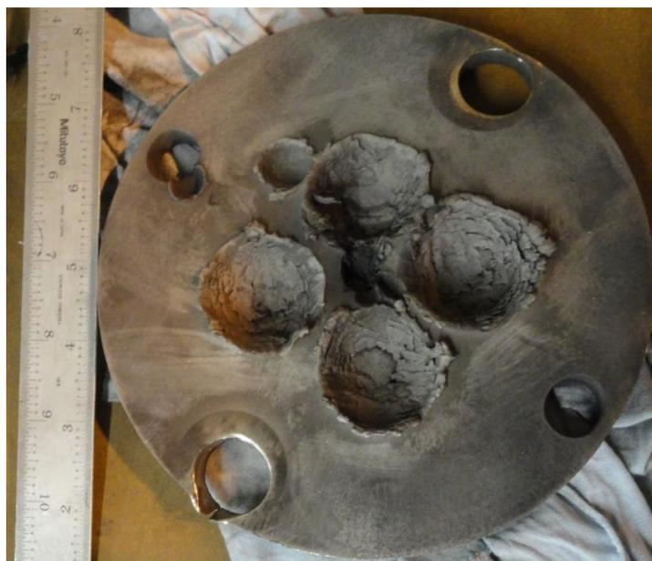
Figure 2-28 : *Stripper plate* d'acier ayant reçu les quatre pétales pesant chacune un peu plus d'un gramme.
