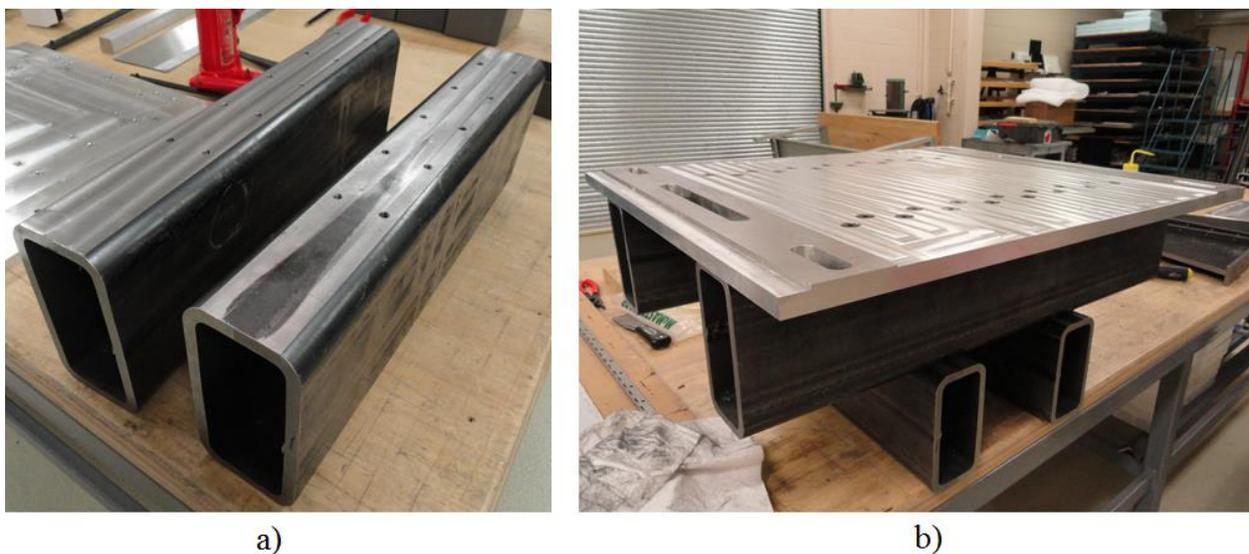
Figure 2-14 : Fabrication de la base du montage. a) Profilés standards découpés et percés servant d'appuis pour élever le cylindre au niveau de la machine uniaxiale. b) Assemblage des profilés découpés et de la plaque d'interface avec le sol. Les rainures sur le côté de la plaque permettent de visser la base du montage dans le plancher du laboratoire.
