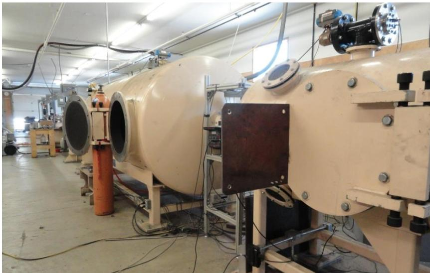
Figure 2-24 : Photo prise au laboratoire de HIT Dynamics montrant au premier plan la chambre d'impact. La chambre à haute pression se situe juste devant la porte entrouverte que l'on peut voir à l'arrière-plan.
