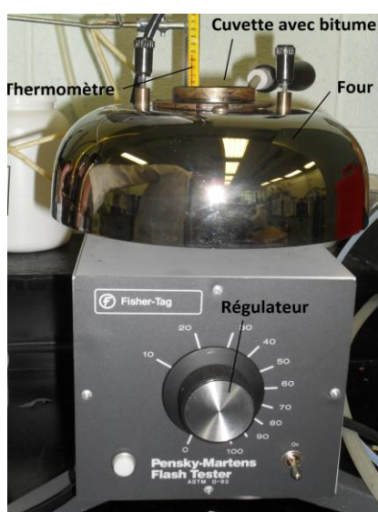
Figure 3-1 : Appareil pour la détermination du point d'éclair (Vase ouvert)
