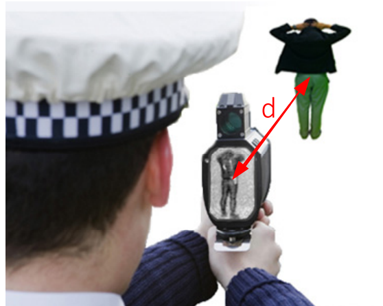
Figure 4-28 : Système d'imagerie passive portable pour une application de courte portée.
