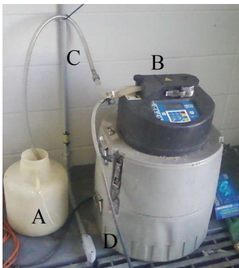
A : Bouteille d'échantillonnage B : Pompe péristaltique C : Ligne de sortie de l'échantillon D : Ligne de pompage de l'échantillon
