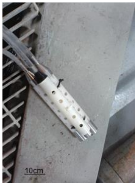
Figure 3-2 : Disposition des crépines utilisées pour le prélèvement des échantillons
