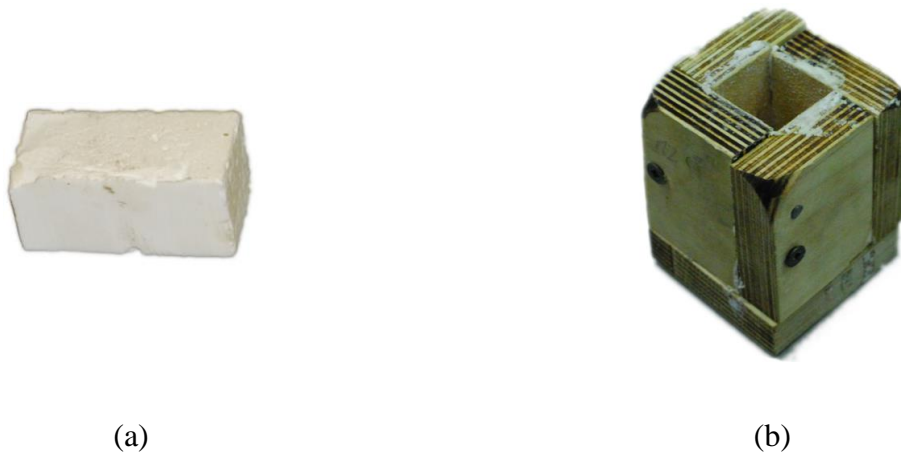
Figure 5-15 : (a) Segment de résine chargée avant meulage; (b) Moule pour cuisson de la résine chargée.
