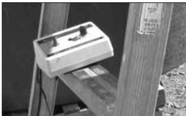
Photo 7C : Régulateur de fréquence pour varier la vitesse
