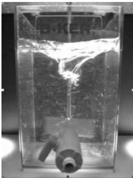
Photo 4C : Vortex engendré à 300 rpm avec une plaque d'agitation standard
