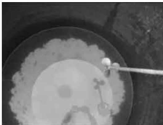
Photo 7D : Partie du surnageant éclairci, hélice et boues décantées
