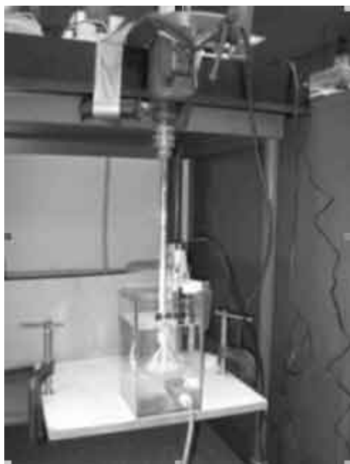
Photo 4E : Montage avec perceuse et hélice de 6 cm de diamètre par 10 cm de longueur
