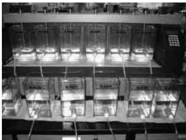
Photo 4A : Six B-Ker 2 sur banc de Jar test et six B-Ker 2 au bas pour recueillir le surnageant décanté
