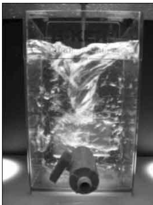
Photo 4D : Vortex engendré à 300 rpm avec une plaque d'agitation du double
