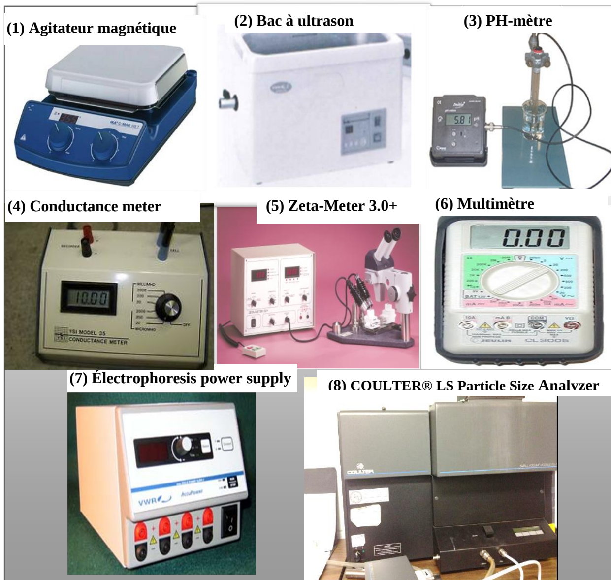
Figure annexe-1: Photos illustrant les différents équipements utilisés pour préparer et caractériser les suspensions
