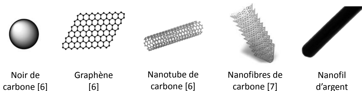
Figure 1-1: Schéma des nanoparticules utilisées pour accroître la conductivité électrique des polymères.
