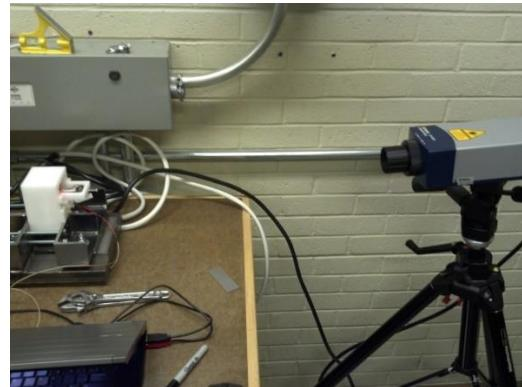
Figure 3-9 : Position du vibromètre laser
