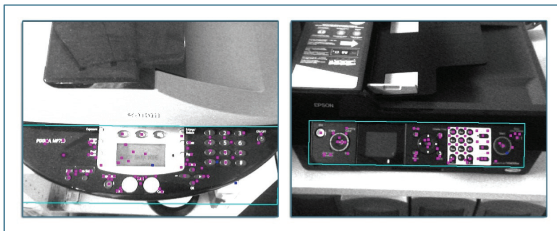
Figure 5.12 : Détection des interfaces matérielles des appareils multifonctions retenus; les points roses représentent les points clés pour lesquels une correspondance avec les caractéristiques de référence a été établie.
