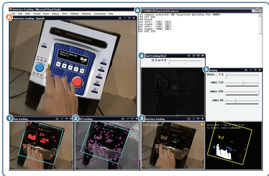
Figure 4.10 : Placement et intégration d'une interface personnalisée face à une chaîne stéréophonique Panasonic SA-AK520, incluant l'identification de l'extrémité du doigt actif et l'utilisation d'un masque d'affichage lors du rendu de l'interface (A); les écrans de contrôle du flot optique (1) et de détection SIFT (2), l'image originelle (3), les écrans de segmentation des mains (4, 5) et la console de débogage (6) sont aussi présentés.
