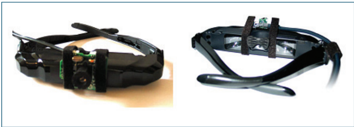
Figure 4.3 : Dispositif d'affichage tête haute, incorporant le capteur CCD utilisé, monté en position centrale (vue de face, à gauche et vue de derrière, à droite)
