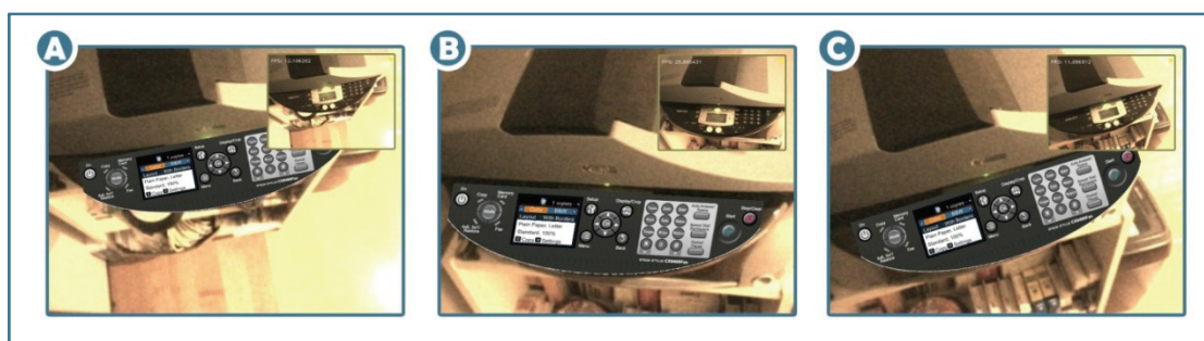
Figure 5.16 : Imposition, face à un appareil Canon MP750 inconnu de l'utilisateur, d'une interface virtuelle familière calquée sur celle du Epson CX9400Fax; les images originelles situées dans les coins supérieurs droits furent rajoutées post-capture, à titre informatif.
