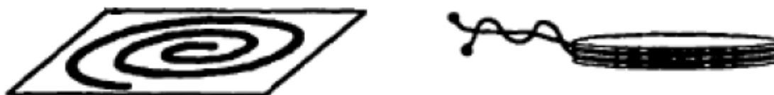
Figure 4.9 : Formes de bobines : (a) bobine imprimée sur PCB ; (b) bobine enroulée
