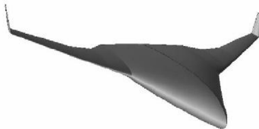
Figure 0.9: Modèle de BWB dans le cadre du projet MOB par l'université de Sheffield [1]
