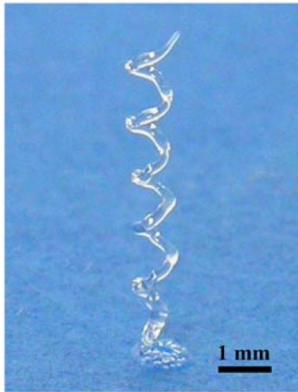
Figure 6 : Spirale fabriquée par écriture directe avec une encre polymère thermoplastique [54].
