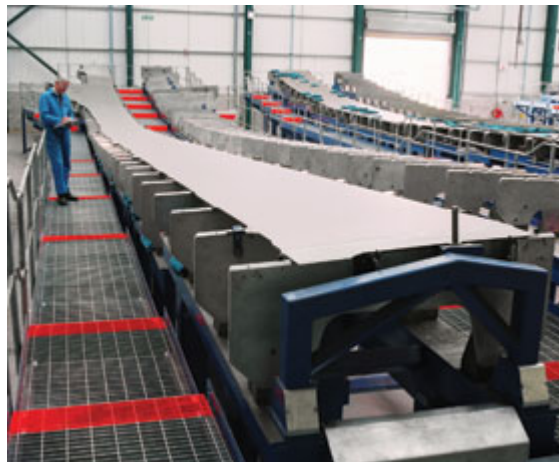
Figure 1.16 Voilure posée sur son gabarit de conformité 2
