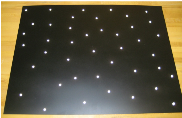
Figure 3.1 Plaque en alliage 6061 T6 peinte en noir avec les pastilles de positionnement
