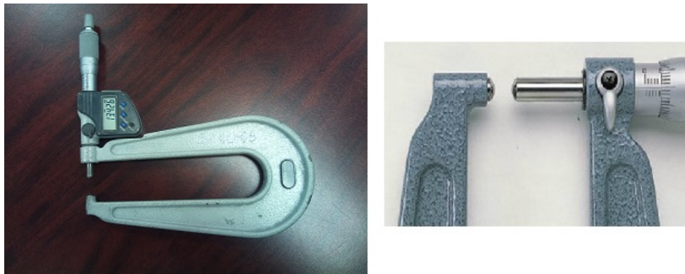
Figure 2.8 Micromètre Mitutoyo (gauche) et détail de la broche de mesure de type sphérique-sphérique (droite)
