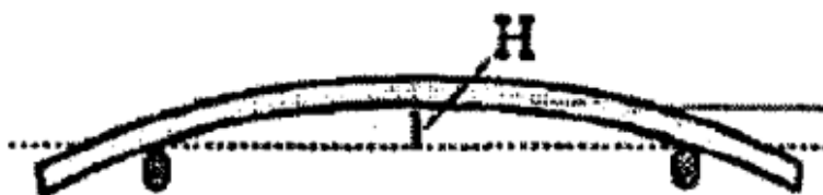
Figure 1.5 Déflexion du coupon test Almen (Tufft, 1999)
