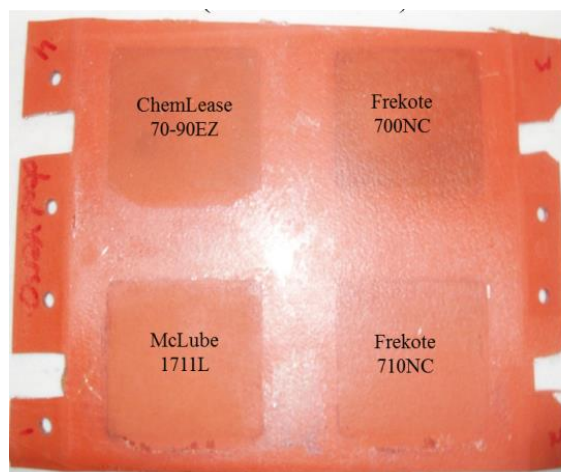
Figure 5-2 : Membrane après 16 fabrications avec un renfort mat et la résine phénolique.
