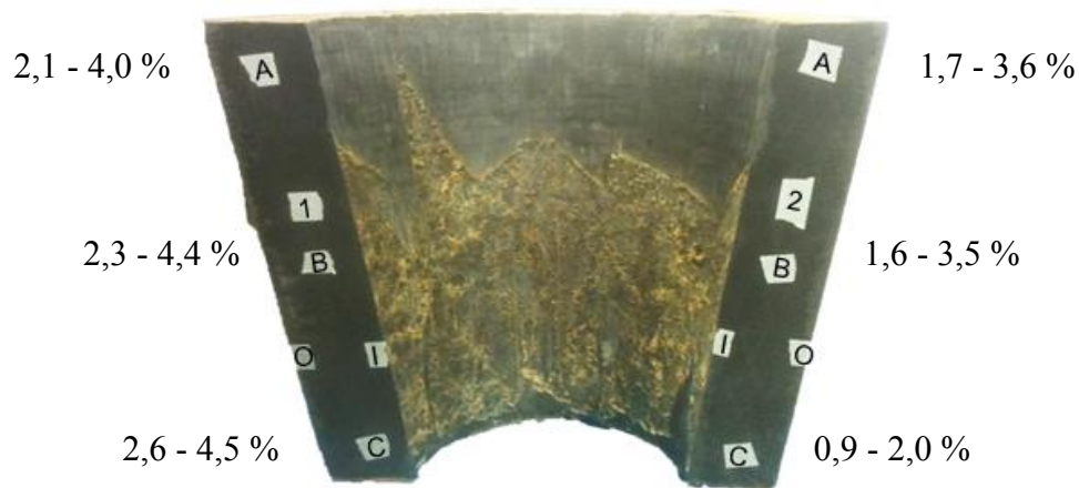
Figure 7-12 : Mesure des porosités au microscope sur la pièce P2.
