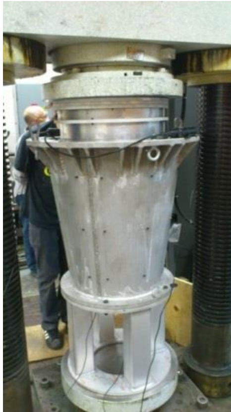
Figure 2-30 : Outil de compaction dans sa position finale avant l'essai de compaction externe.
