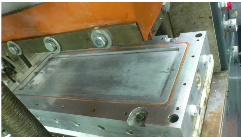
Figure 8-3 : Corrosion sur le moule de plaque Polyflex après 4 fabrications.
