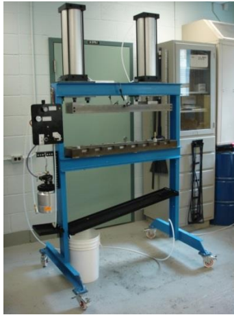
Figure A1.2 : Banc d'essai de mesure de perméabilité planaire (Demaria, 2008).
