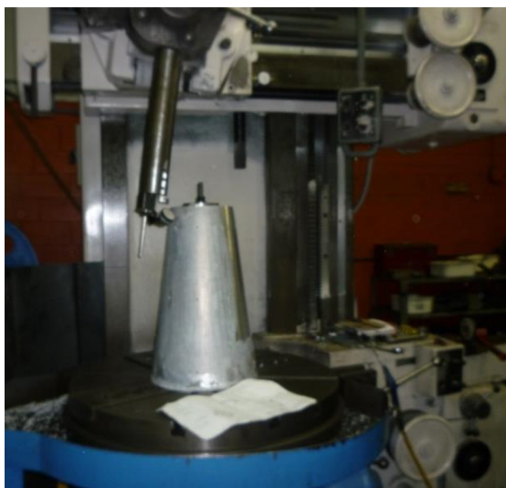
Figure 2-13 : Usinage du cône intérieur de l'outil de compaction.
