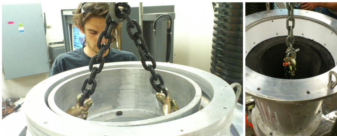
Figure 2-31 : Retrait du cône intérieur et de la préforme P2.
