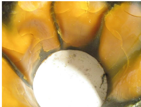
Figure 7-7 : Zone riche en résine sur la surface interne de la pièce P2.
