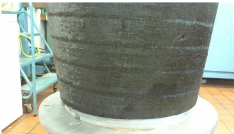
Figure 2-33 : Préforme P2 à la sortie de l'essai de compaction externe.
