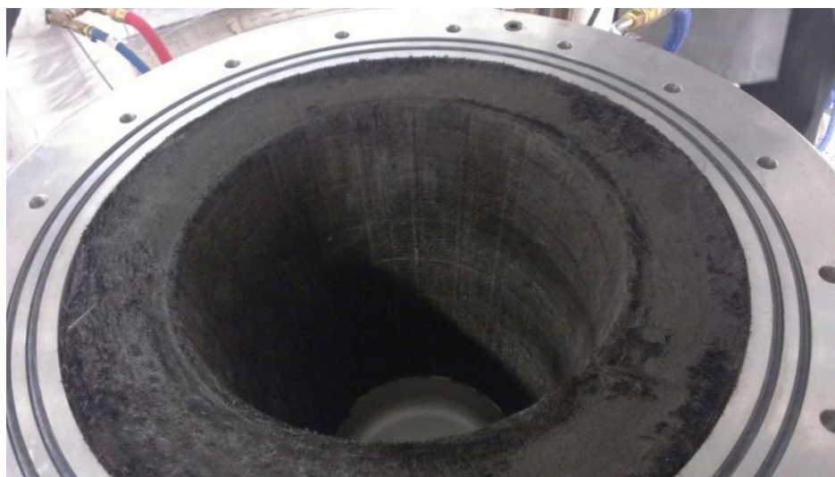
Figure 7-1 : Insertion de la préforme P2 dans le moule.
