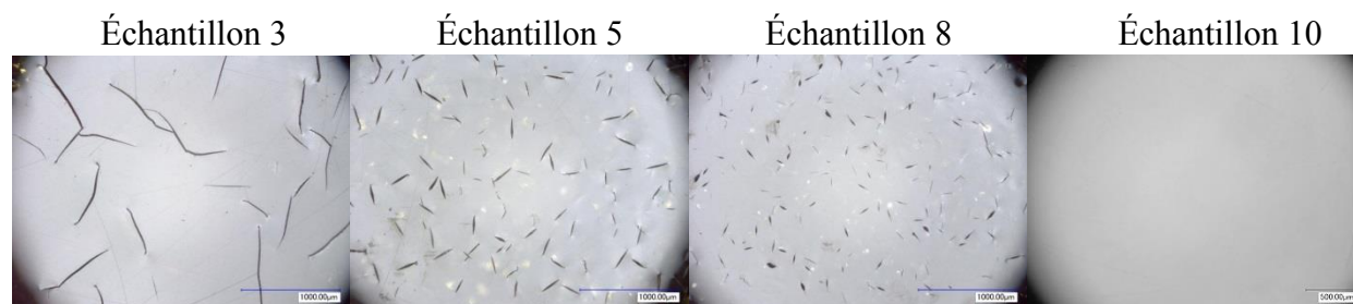
Figure 3-13 : Observations au microscope des échantillons de résine phénolique fabriqués au NanoMoule .
