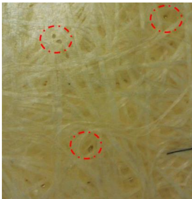
Figure 6-7 : Porosités à la surface de la pièce 2.
