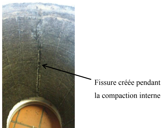
Figure 2-26 : Vue de la surface intérieure de la préforme P2 après le 2 e essai de compaction.
