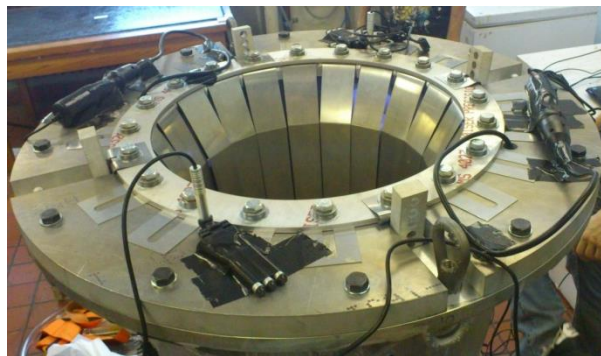
Figure 2-17 : Installation de la plaque des languettes et des caméras.
