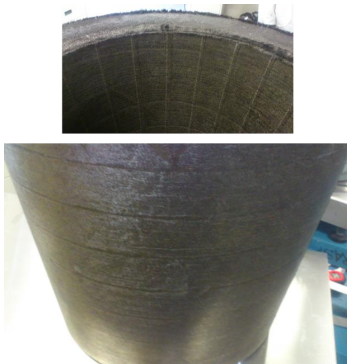
Figure 9-2 : Renfort P3 après l'opération de préformage.
