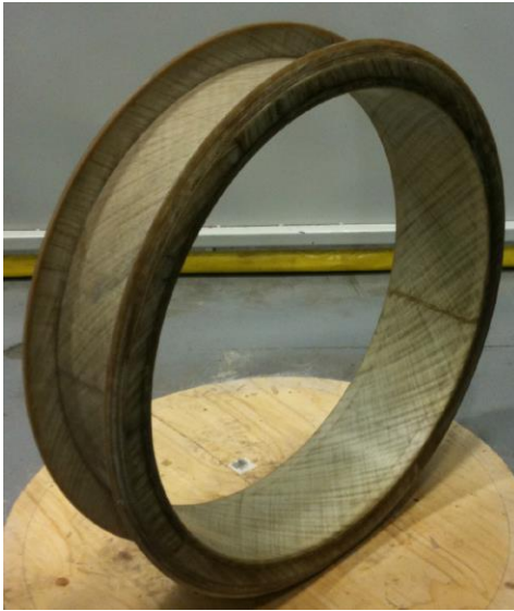
Figure 1-3 : Première pièce axisymétrique fabriquée par Polyflex (Ferreira-Benevides, 2011).
