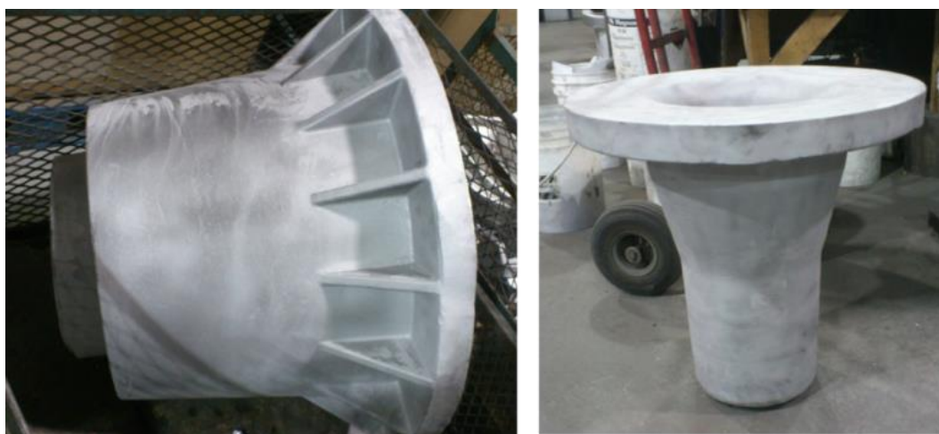
Figure 5-10 : Moule intérieur et extérieur après le coulage et le traitement T6.
