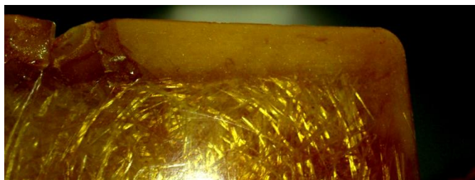
Figure 6-10 : Présence de cristaux dans les zones riches en résine de la pièce 3.
