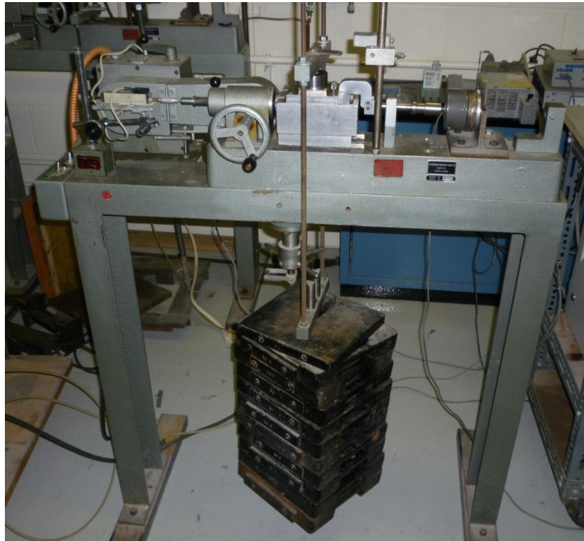
Figure A5.5 Montage lors du chargement de 168 kg.
