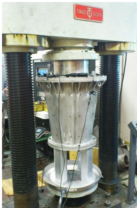
Figure 2-20 : Outil de compaction dans sa position finale avant l'essai de compaction interne.
