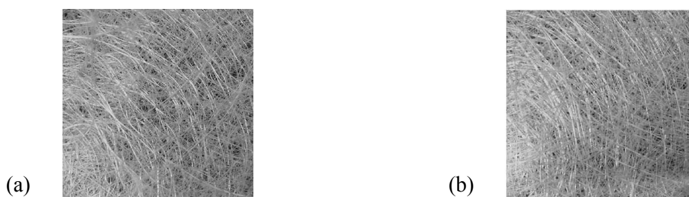
Figure 1-1: Exemple de renfort collé 2D : (a) mat à fils continus et (b) mat à fils coupés (Bickerton et al., 2003).
