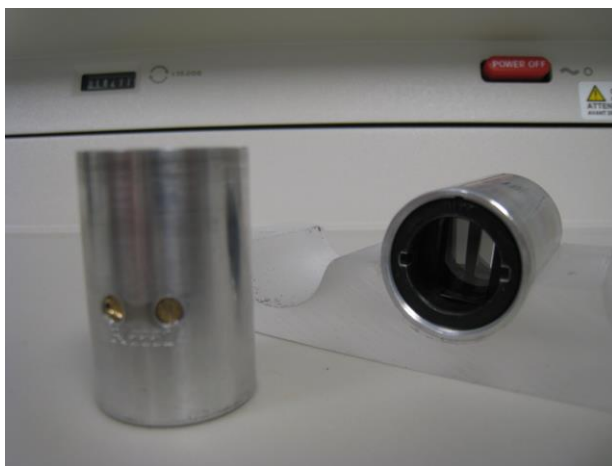
Figure 9. Exemple de cellules d'analyse d'AUC avec une pièce centrale à double secteur.
