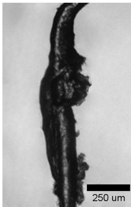
Figure 5-1 – Jonction entre deux sections du canal ayant une forme irrégulière qui cause des gradients de champ électrique locaux.
