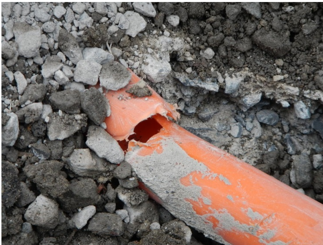
Figure 5.3 : Conduite de gaz touchée (source Gaz Métro)
