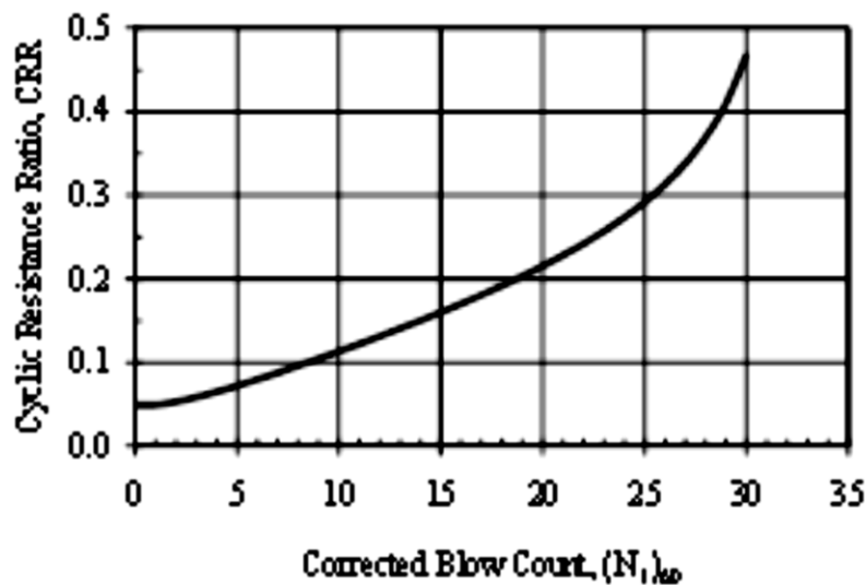
Figure 1- 40 Calcul du rapport de résistance (CRR) pour un séisme de magnitude de 7.5 à partir du nombre de coups de l'essai SPT, (figure tirée de Youd et al. , 2001)
