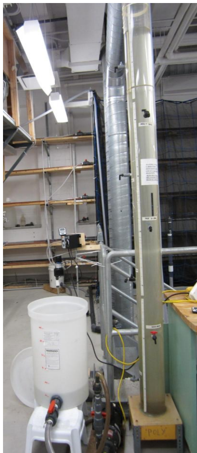
Figure 3.2 Photographie du montage expérimental de remise en suspension des sédiments
