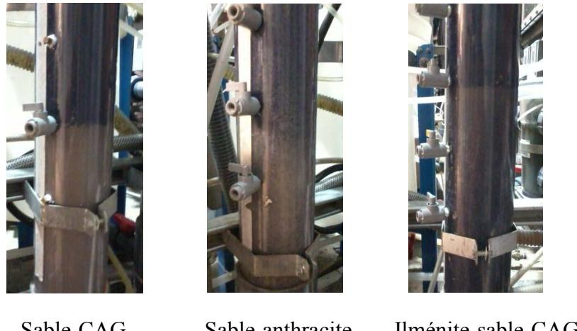
Figure 4.19 : Différentes interfaces entre les médias filtrants
