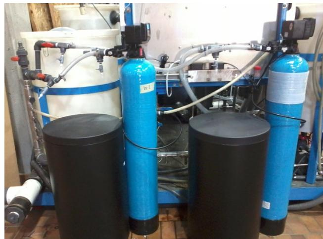
Figure 2.6 : Systèmes d'échange ionique
