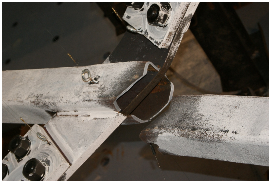
Figure 4-7: Rupture du spécimen no. 8.
