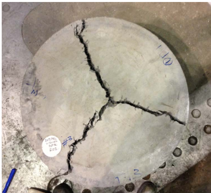
Figure 5-8 : Photographie d'une dalle ayant brisé en trois fissures
