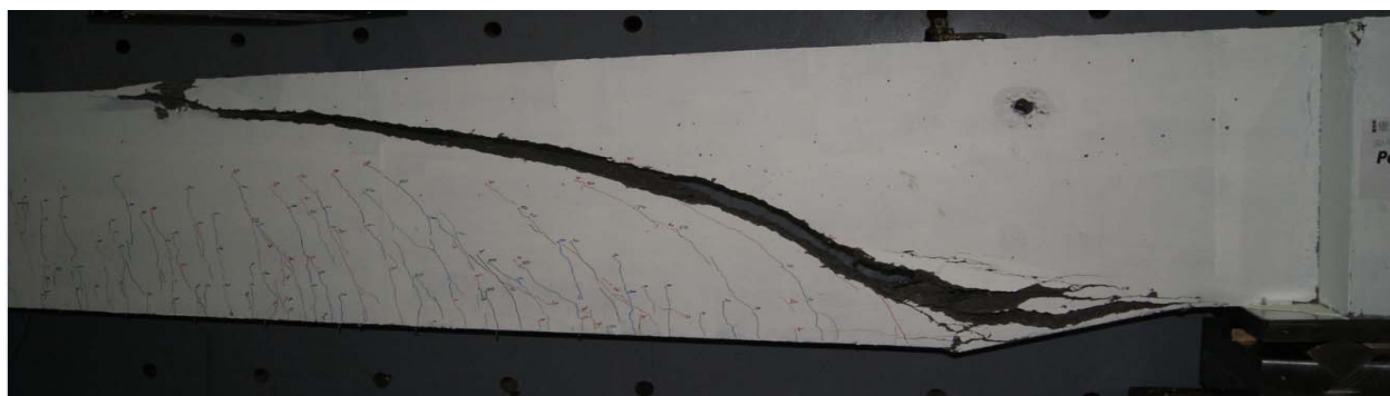
Figure 5-21 : R03 - Fissure principale de cisaillement
