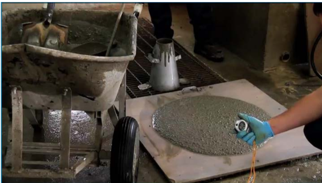
Figure 2-14 : Étalement au cône d'Abrams
