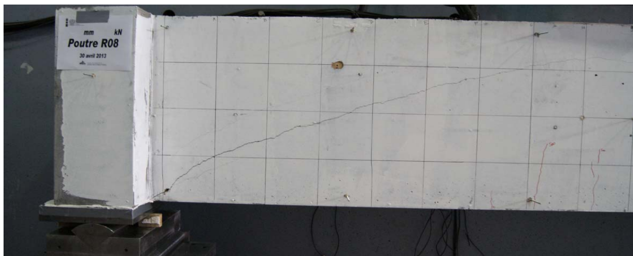
Figure 5-33 : Photographie de la rupture en flexion de la R08
