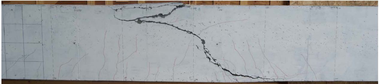
Figure 5-24 : Relevé des fissures de la poutre R06-2
