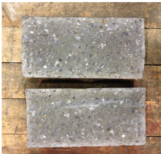
Figure 5-14 : Cylindre 6 pouces après l'essai brésilien - R08
