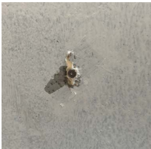
Figure 4-27 : Point DEMEC collé sur la face d'une poutre
