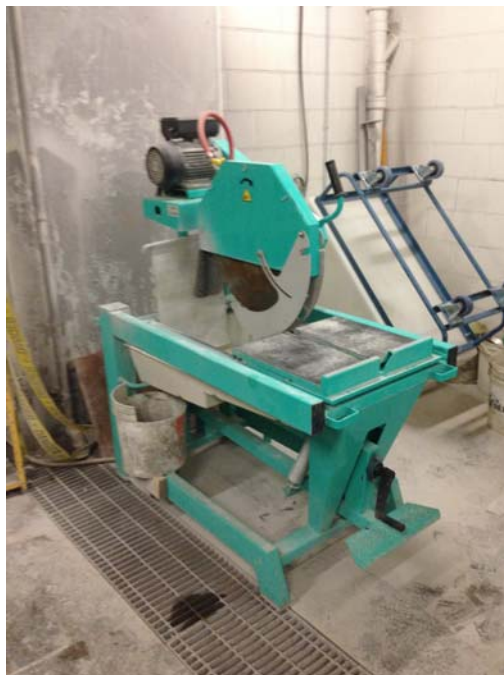
Figure 4-5 : Scie à béton du laboratoire de l'EPM
