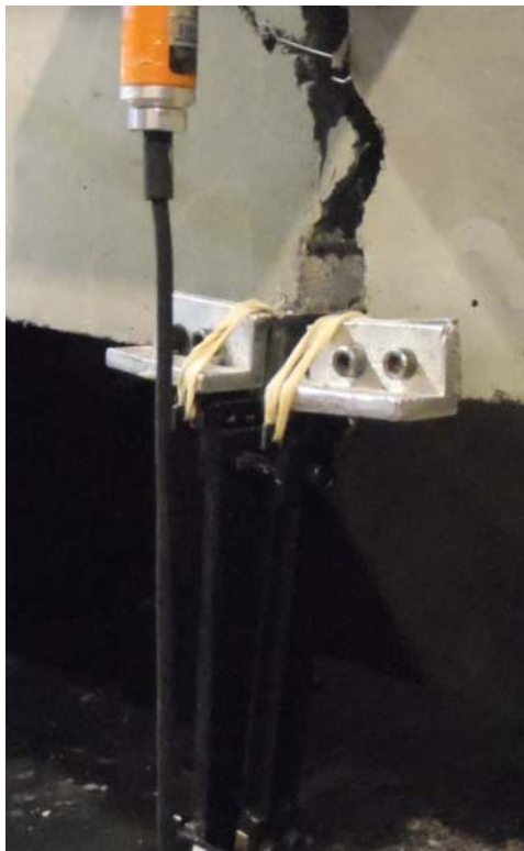
Figure 4-6 : Extensomètre fixé dans la fente du prisme
