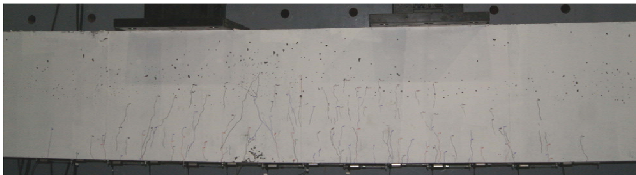
Figure 5-19 : R02 - Vue d'ensemble du relevé de fissures
