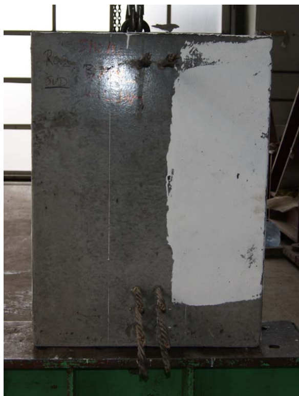
Figure 4-20 : Position des torons sur les poutres en flexion R01-R04
