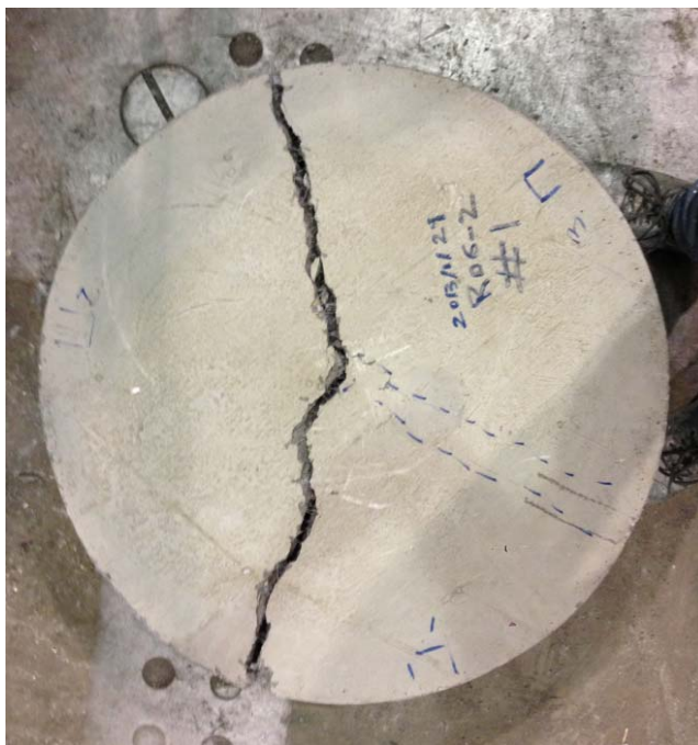
Figure 5-7 : Photographie d'une dalle s'étant brisée en deux fissures
