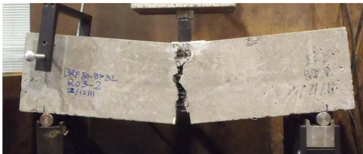
Figure 5-2 : Photographie d'un spécimen ayant fissuré correctement
