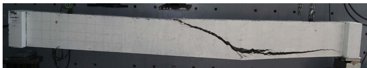
Figure 5-27 : Photographie de la rupture en cisaillement de la R06-1
