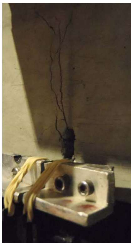
Figure 5-1 : Photographie d'un prisme ayant multi-fissuré
