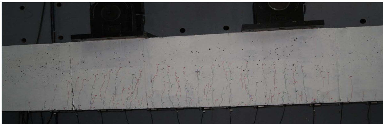
Figure 5-23 : R05 - Vue d'ensemble du relevé des fissures
