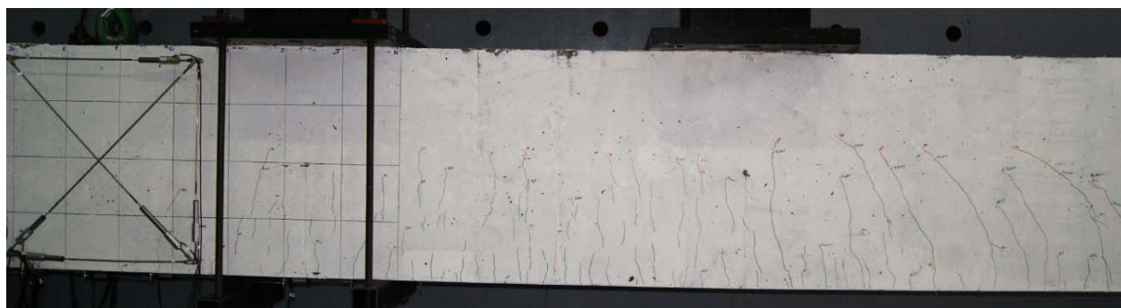
Figure 5-26 : Relevé des fissures de la poutre R06-1
