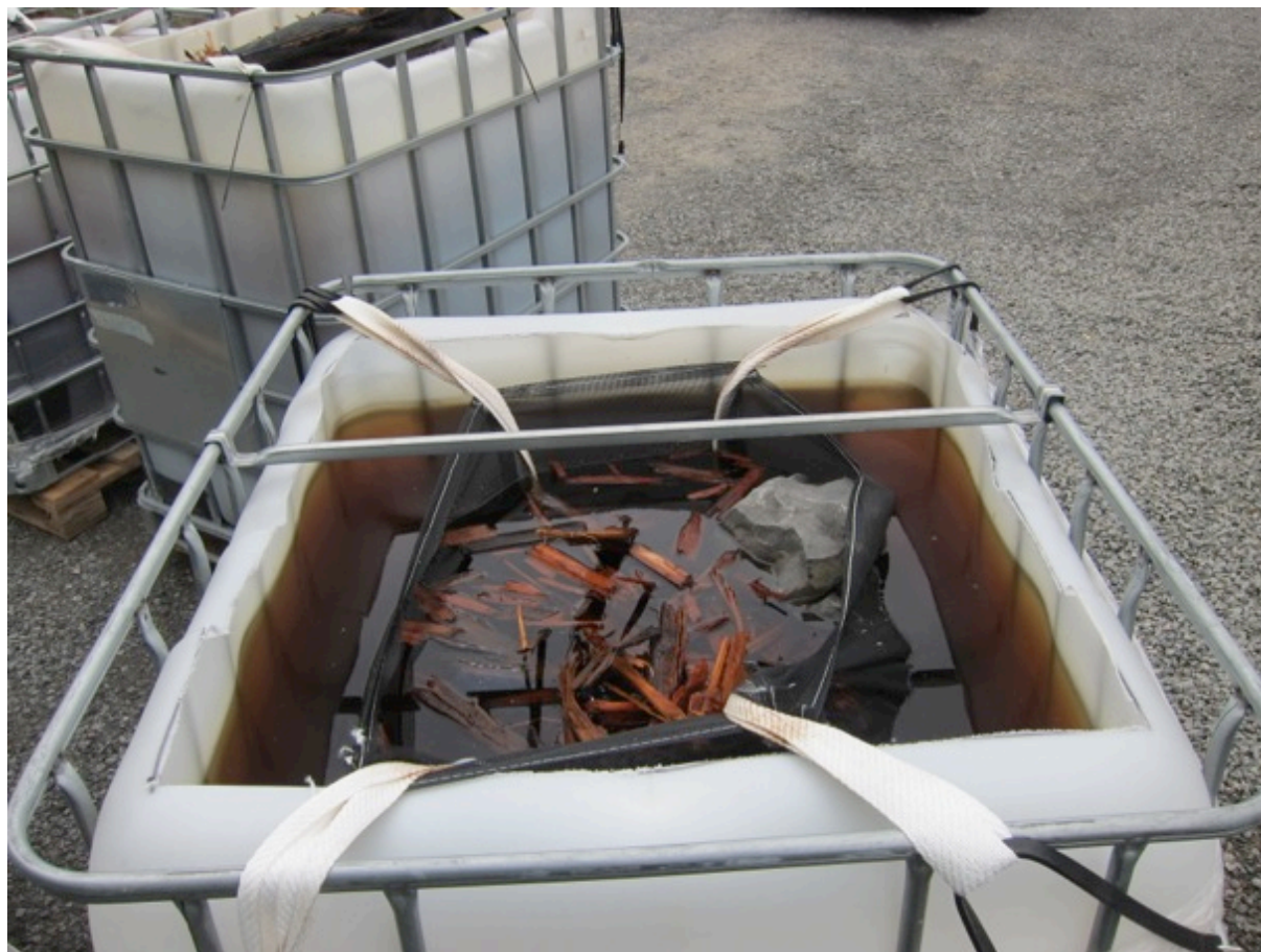
Figure 2-4 : Réservoir de macération pour fortification de l'affluent
