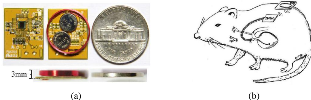
Figure 3-17: (a) Prototype de pacemaker miniature et (b) schéma d'implantation sur un rat. (© 2011 IEEE, [110])
