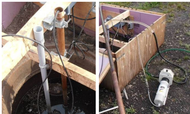
Figure 3.3 : Tube en PVC installé en parallèle des sondes (photo de gauche) et pompe d'échantillonnage sur le site de L'Assomption (photo de droite)
