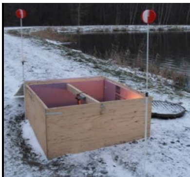
Figure 3.10 : Boîte protectrice de la sonde 1-2 à L'Assomption. Un couvercle isolé amovible protège l'enregistreur des intempéries.
