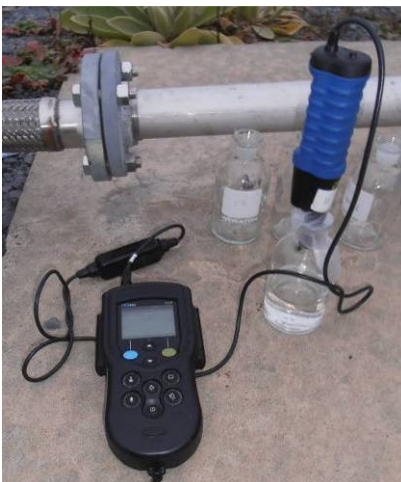
Figure 3.6 : Montage de la sonde à oxygène dissous et de l'enregistreur Hach
