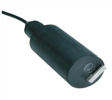
Figure 3-10 : Sonde Solitax avec essuie-glace pour mesurer les MES à l'affluent et au tamisat
