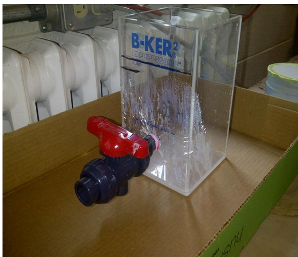
Figure 3-2 : Bêcher de 2 litres avec valve pour les essais de Jar test modifié (phase 3)
