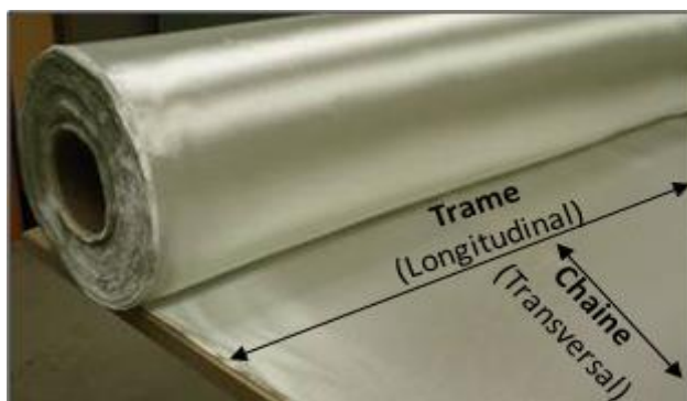
Figure 4-15: Les sens longitudinal et transversal de la plaque.
