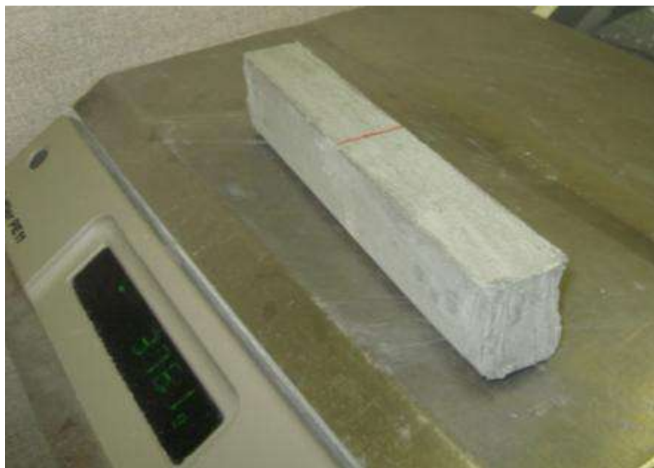
Figure 3–15 : Pesée de l'éprouvette avant d'être placée dans le montage d'essai de flexion.
