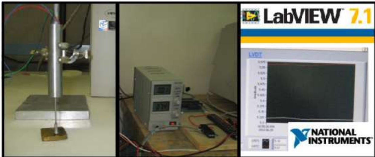
Figure 3-13 : Éléments utilisés pour la calibration du capteur LVDT
