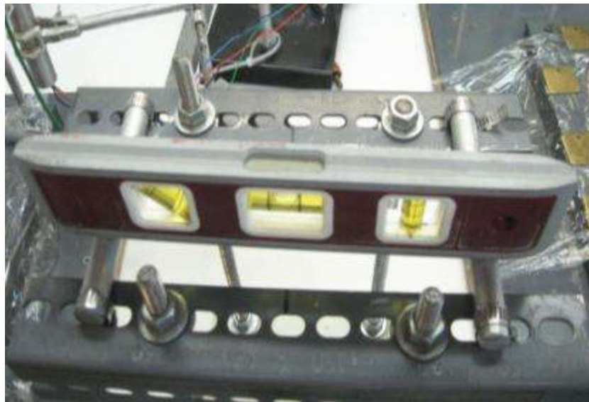
Figure 3–14 : Préparation du montage pour assurer l'horizontalité du système d'appui.
