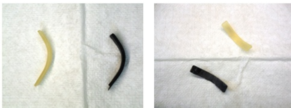
Figure 3-22 : Photos des échantillons de l'adhésif 1 (jaune) et l'adhésif 2 (noire) après un essai dynamique en température en DMA.
