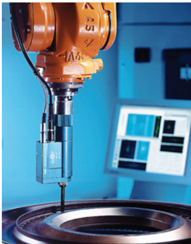
Figure 2.4 Système automatisé d'inspection par courants de Foucault avec un bras manipulateur (Eloscan). Extrait de Rohmann GmbH (2008).
