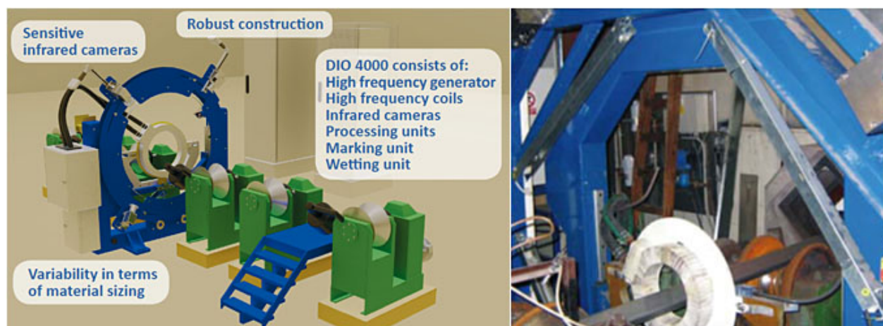
Figure 2.5 Système IRT automatisé (modèle DIO 4000 de l'entreprise STARMANS) pour la détection de fissures sur des barres d'acier (billettes) de section carrée ou arrondie. Extrait de STARMANS electronics Ltd. (2013).
