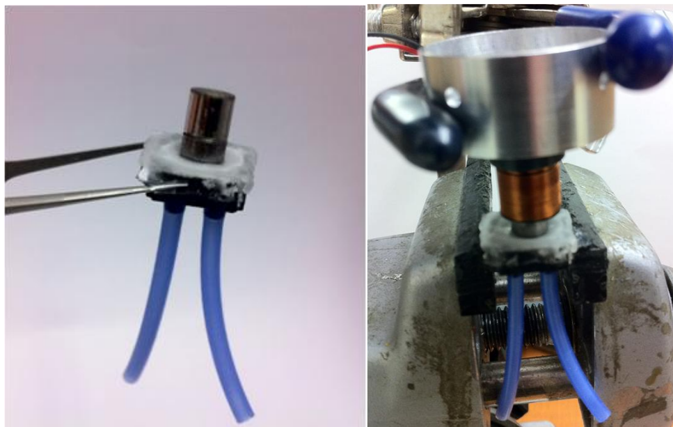
Figure 4.11: Prototypage de la deuxième micropompe assemblée.
