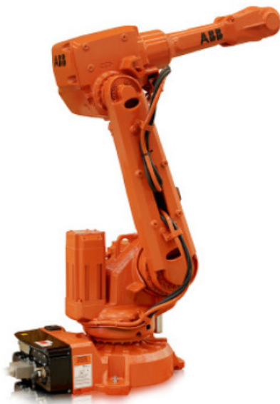
Figure 1-1 Exemple de manipulateur sériel : Robot IRB 2600 de ABB
